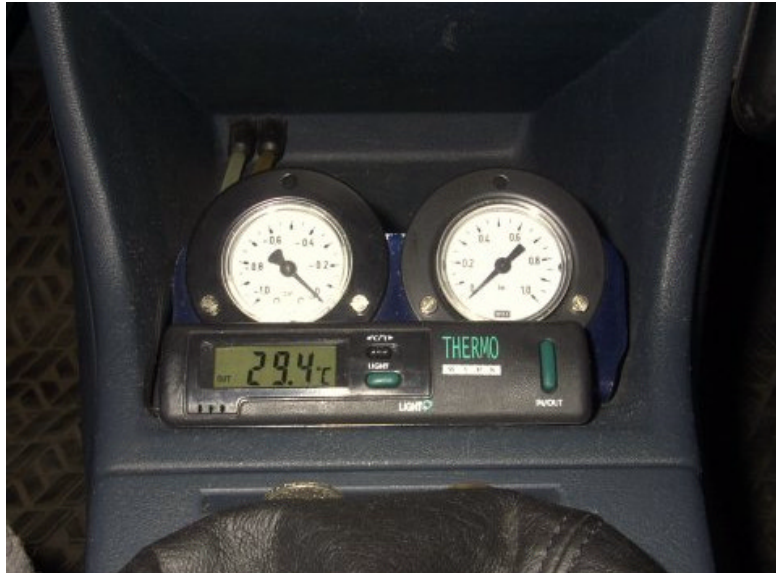
Eine Soganzeige, eine Ladedruckanzeige und ein Außenthermometer im Passat des Autors
