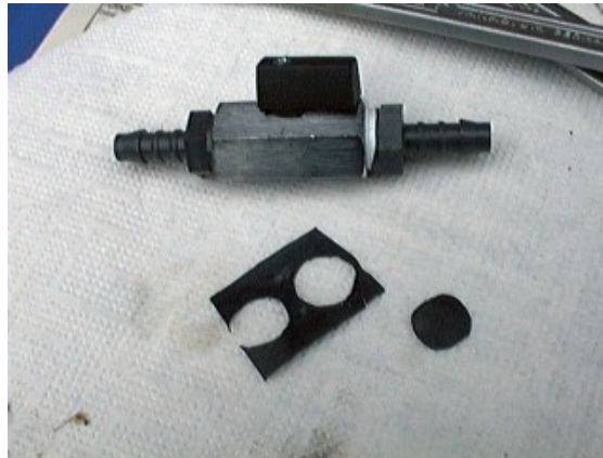
Umschalhähne mit Teflon und Gummidichtung
