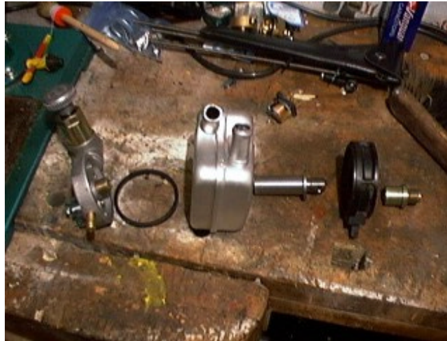
Hier die Einzelbauteile des Filterkombis (noch ohne abgesägte Adapterhülsen)
